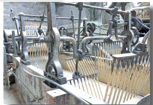
L'un des quatre bacs de lavage.
